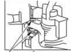
GAZ KOLU BAĞLANTILARI
