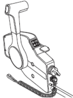
YAN TARAF MONTEDİLEN TİP UZAKTAN KUMANDA KUTUSU
